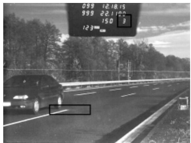
Abb. 6.9.5: Registrierungsfoto ^{\circ} P 80 / VIII-4; die Messlinie befindet sich innerhalb des Rechtecks
