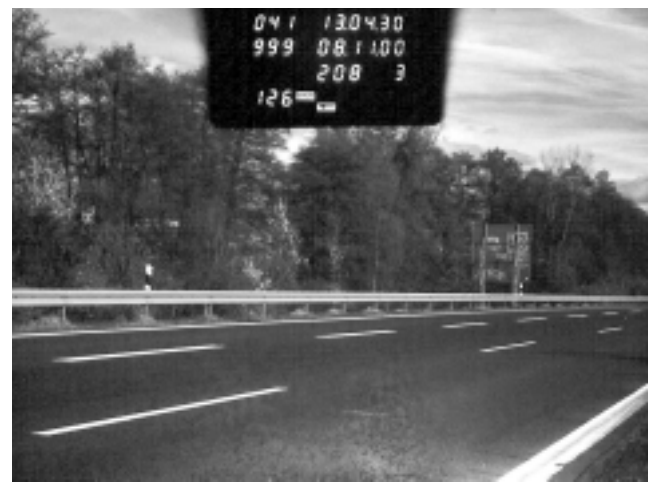
b) Messfoto von Kamera 2 mit Geschwindigkeit, aber ohne Fahrzeug
