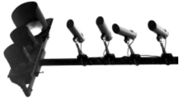
Abb. 2.8.4: Ultraschalldetektoren am Auslegemasten
