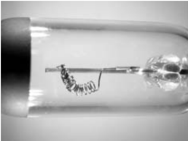
Abb. 6.8.1: Verformung der Glühwendel einer H7-Lampe
