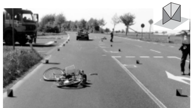
Abb. 1.8.4: Markierungstafeln erleichtern das Auffinden der Passpunkte oben rechts: vergrößerte Darstellung eines Markers
