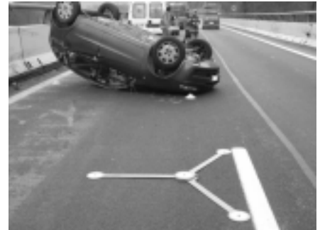
c) sternförmiges Kalibrierungsobjekt mit Armlängen von jeweils 1 m [M1]
