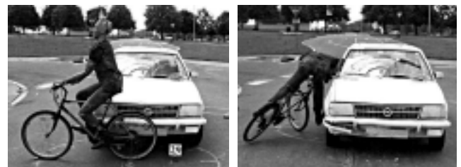
a) Anstoß schräg von hinten, Kollisionsgeschwindigkeit 13 km/h
